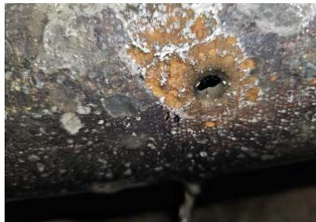
*Elektrokorrosion an Wasserleitung*
