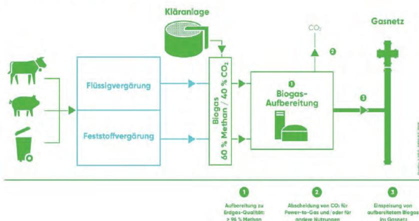
So funktioniert die Erzeugung von Biogas, das auch in Amriswil verwendet wird.
