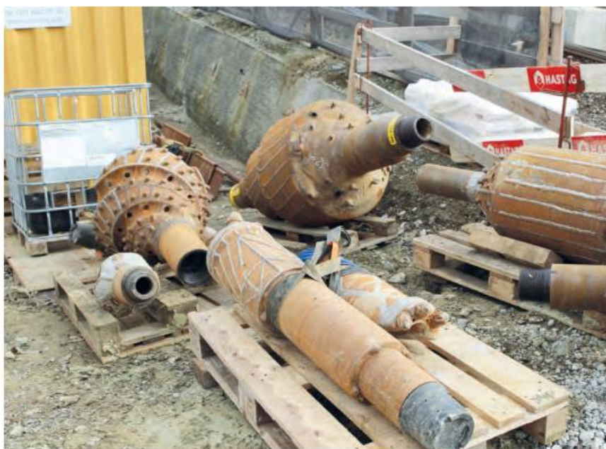
Mit solchen Bohrern wird ein Tunnel in den See gebohrt, durch den die neuen Leitungen gezogen werden. Bild: red
